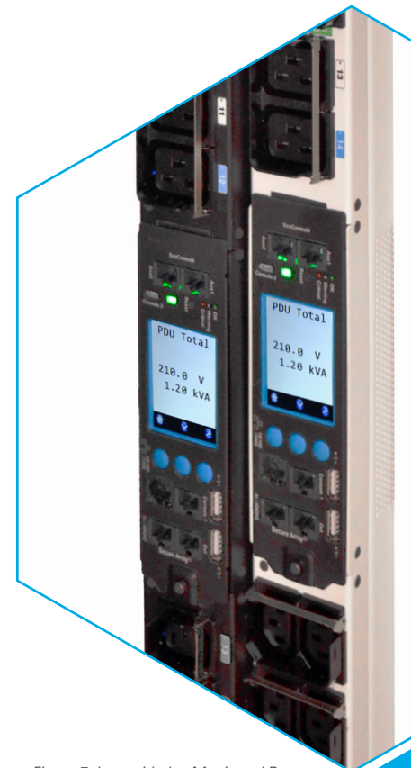
Figura 7: Las unidades Monitored Pro eConnect PDU de CPI cuentan con monitoreo local y remoto de la energía en la entrada, los disyuntores y los tomacorrientes. Los valores medidos se presentan en la pantalla LCD, a través de la GUI web de la PDU, y se pueden compartir con DCIM y otro software de monitoreo de terceros.
