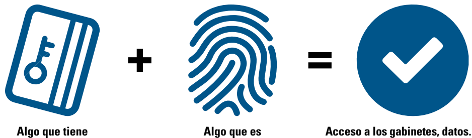
Figura 3: Las cerraduras con capacidades multifactoriales combinan varios tipos de claves para mejorar la seguridad y conectar las credenciales a usuarios autorizados específicos.
