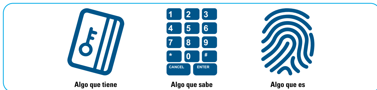
Figura 2: Los sistemas de control de acceso y cierre electrónico tienen tres niveles de seguridad: algo que tiene, algo que sabe o algo que es.
